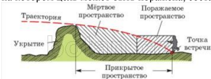
Рис. 52. Прикрытое, поражаемое и мёртвое пространство
