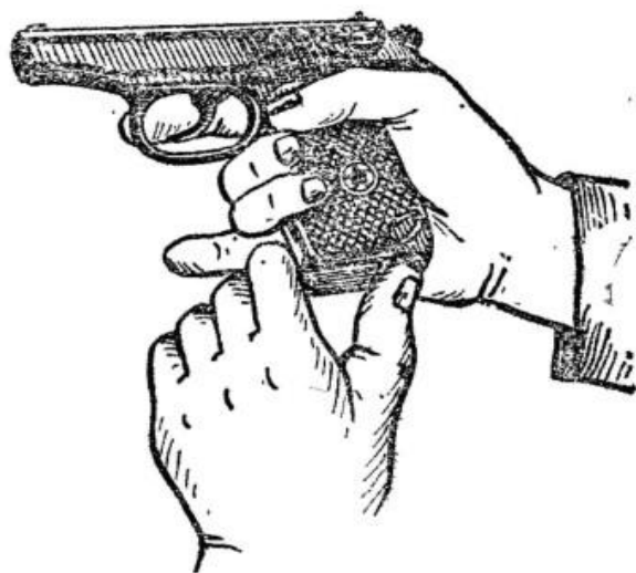
Рис. 3. Извлечение магазина из основания рукоятки
