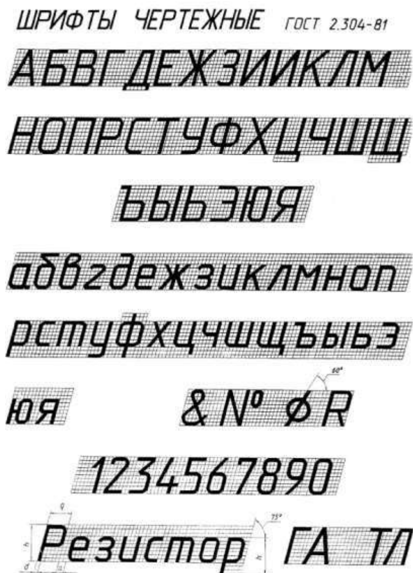
Рисунок 1.1 – Шрифт типа Б с наклоном 75°
