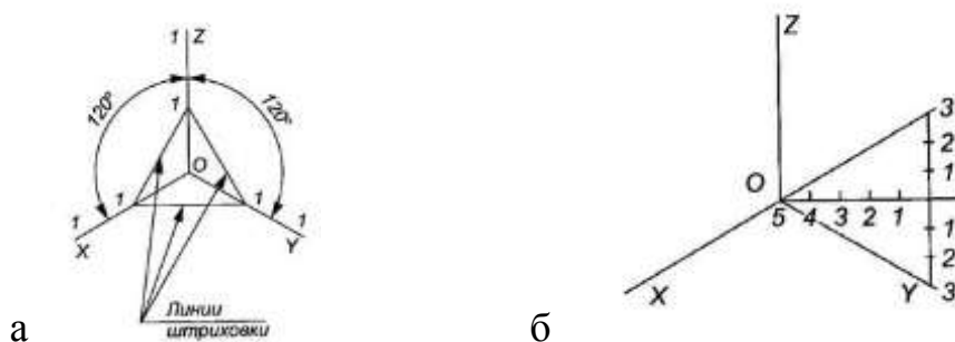
Рисунок 54 – Оси координат в изометрии
