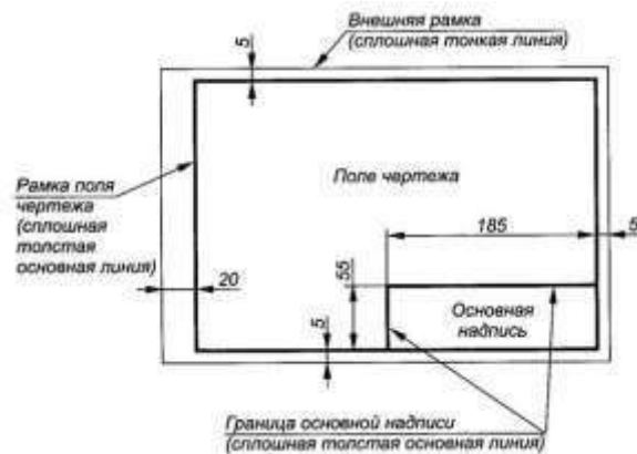
Рисунок 1.1 – Образование формата чертежа Таблица 1.1 – Основные форматы
