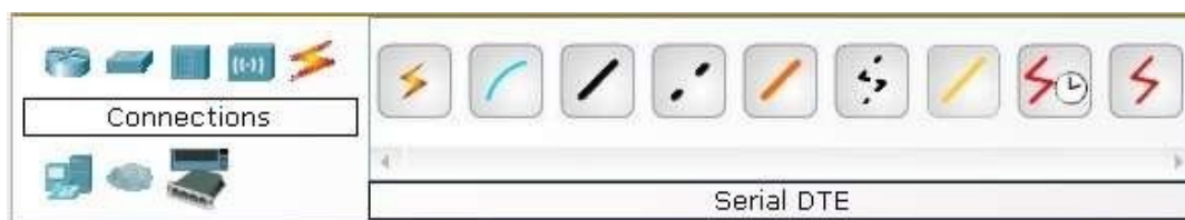
Рисунок 1.3. Поддерживаемые в Packet Tracer типы кабелей
