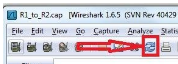
Рисунок 6 - Обновление захваченных пакетов
