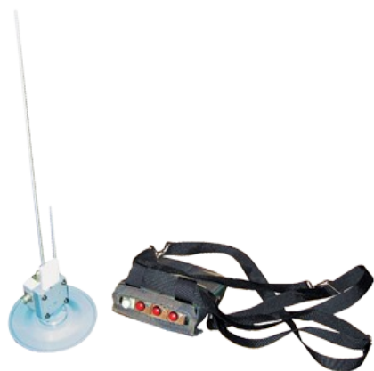
Рисунок 1.7 Система отметки момента по радио каналу
