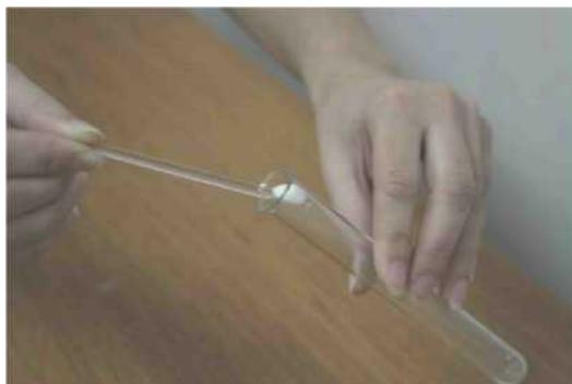
Рисунок 1.3 – Внесение в пробирку порошкообразных веществ
