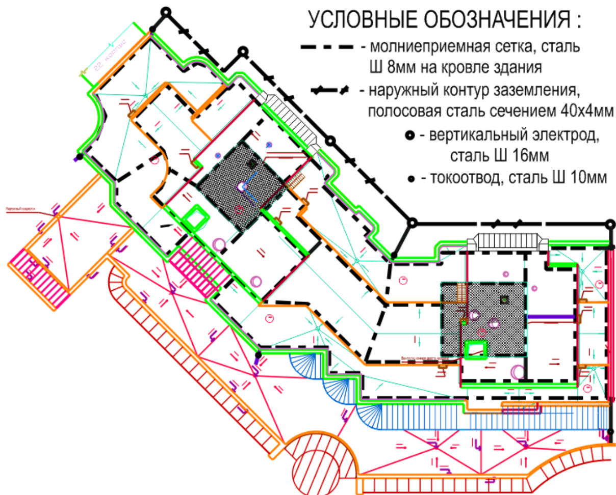
Рисунок 16.8 – Молниезащита и наружный контур заземления секции 1 дома
