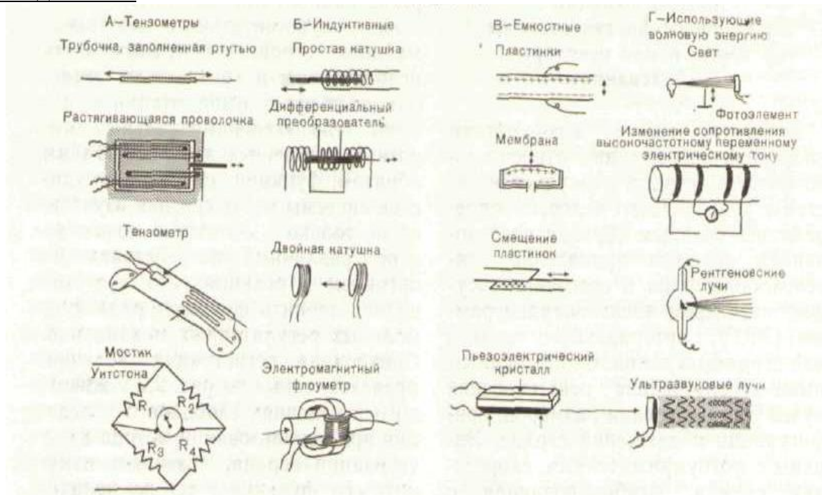
Рис. 2. Достижения электронной техники дают возможность производить электрические измерения неэлектрических величин: давлений, перемещений, размеров и т. д. Эти явления воспринимаются датчиками, т. е. устройствами, в которых указанные воздействия вызывают изменение емкости, индуктивности или электрического сопротивления.
