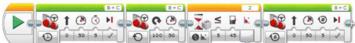
Рис. 64. Программа с использованием гироскопического датчика
