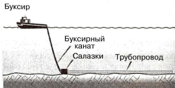
Рисунок 8 - Технологии буксировки и монтажа трубопровода
