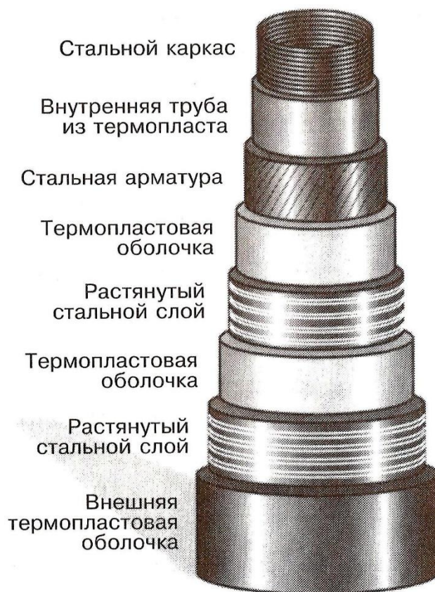
Рисунок 1 - Конструкция гибкого трубопровода
