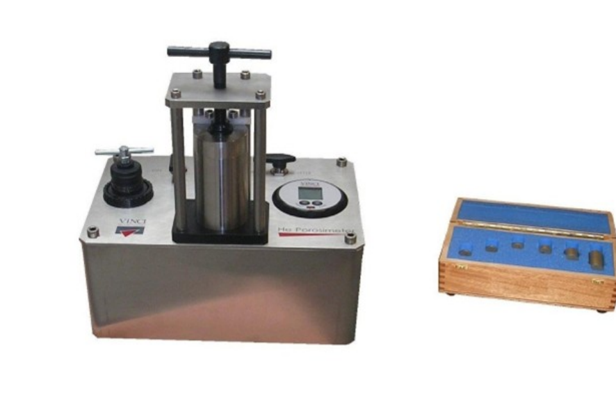
Рисунок 6.2 – Общий вид прибора для измерения пористости
