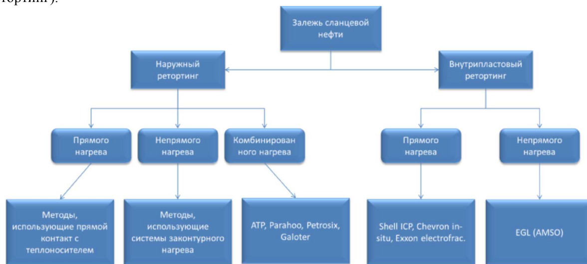
Рисунок - Схема процессов обработки сланцевых плеев для получения нефтяного
