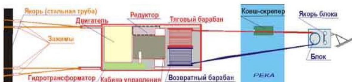
Рисунок 4.3 – Схема монтажа КСУ
