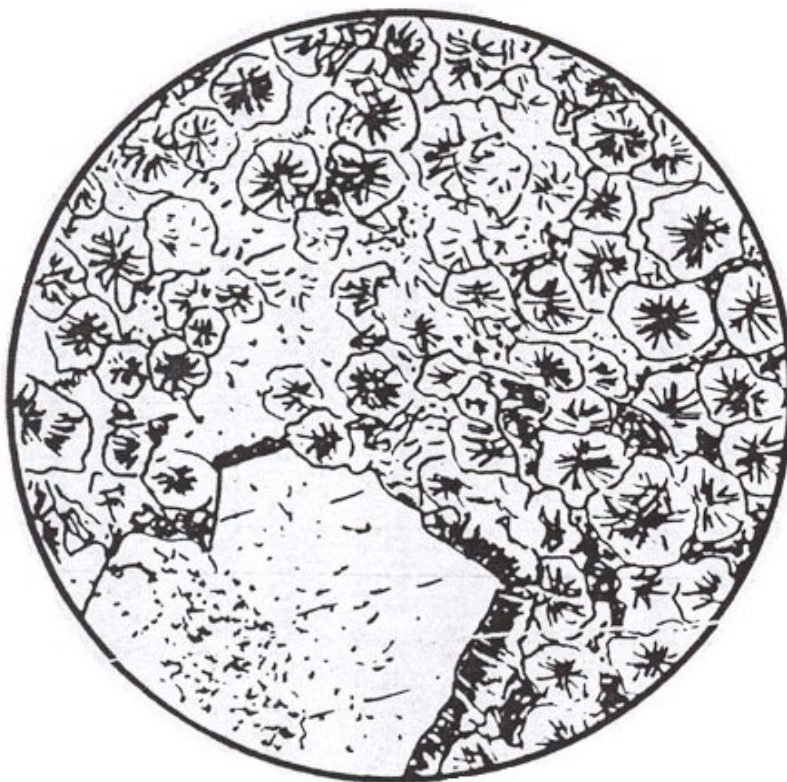
Рисунок 30. Структура скрытокристаллическая сферолитовая
