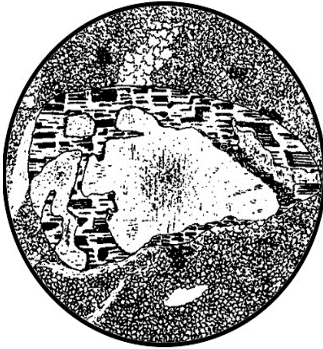
Рисунок 27. Структура порфировая, скрытокристаллическая с фельзитовой структурой основной массы. Фенокристаллы представлены ортоклазом, основная масса смесью кварца и полевых шпатов
