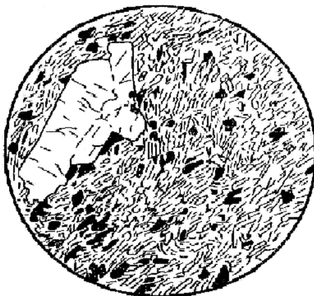
Рисунок 29. Структура неполнокристаллическая порфировая с трахитовой структурой основной массы
