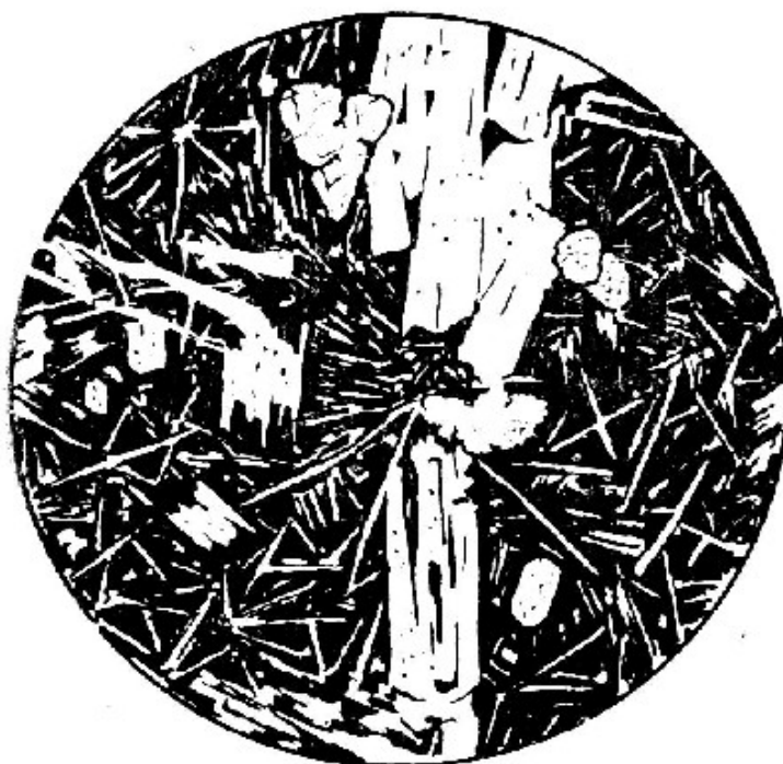
Рисунок 28. Структура неполнокристаллическая порфировая интерсертальная
