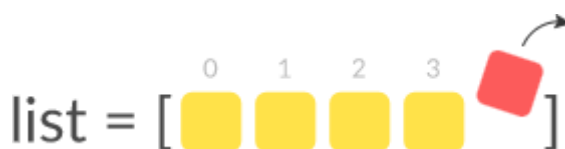
Рисунок 6 – Удаление последнего элемента списка
