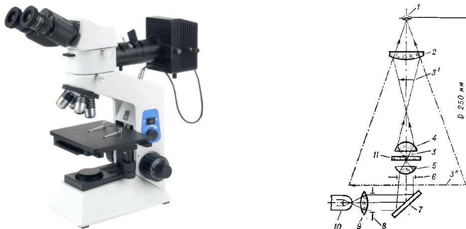
Рис. 5. Общий вид и принципиальная оптическая схема микроскопа с осветителем: 1 – глаз наблюдателя; 2 – окуляр; 3 – рассматриваемый объект; 3' – образуемое окуляром мнимое перевернутое изображение объекта, лучи от которого, проходя через оптические системы глаза наблюдателя, создают на сетчатке глаза действительное изображение объекта; 3'' – перевернутое и увеличенное действительное изображение объекта; 4 – объектив; 5 – конденсор, концентрирующий на объекте пучок света, отражающегося от зеркала; 6 – апертурная диафрагма; 7 – зеркало; 8 – полевая диафрагма; 9 – линза-коллектор осветителя; 10 – источник света; 11 – предметное стекло, на котором располагают рассматриваемый объект; D – расстояние наилучшего видения; стрелками показан ход лучей в оптической системе микроскопа.
