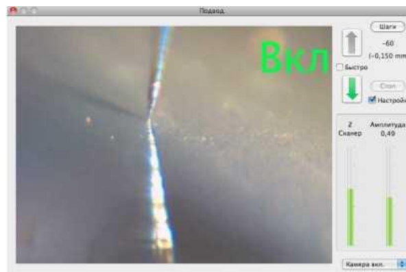
Рис.10. Окно контроля процедуры подведения зонда к анализируемой поверхности образца
