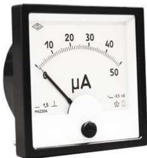
Рисунок 4 - Амперметр. Род измеряемой величины – амперы
