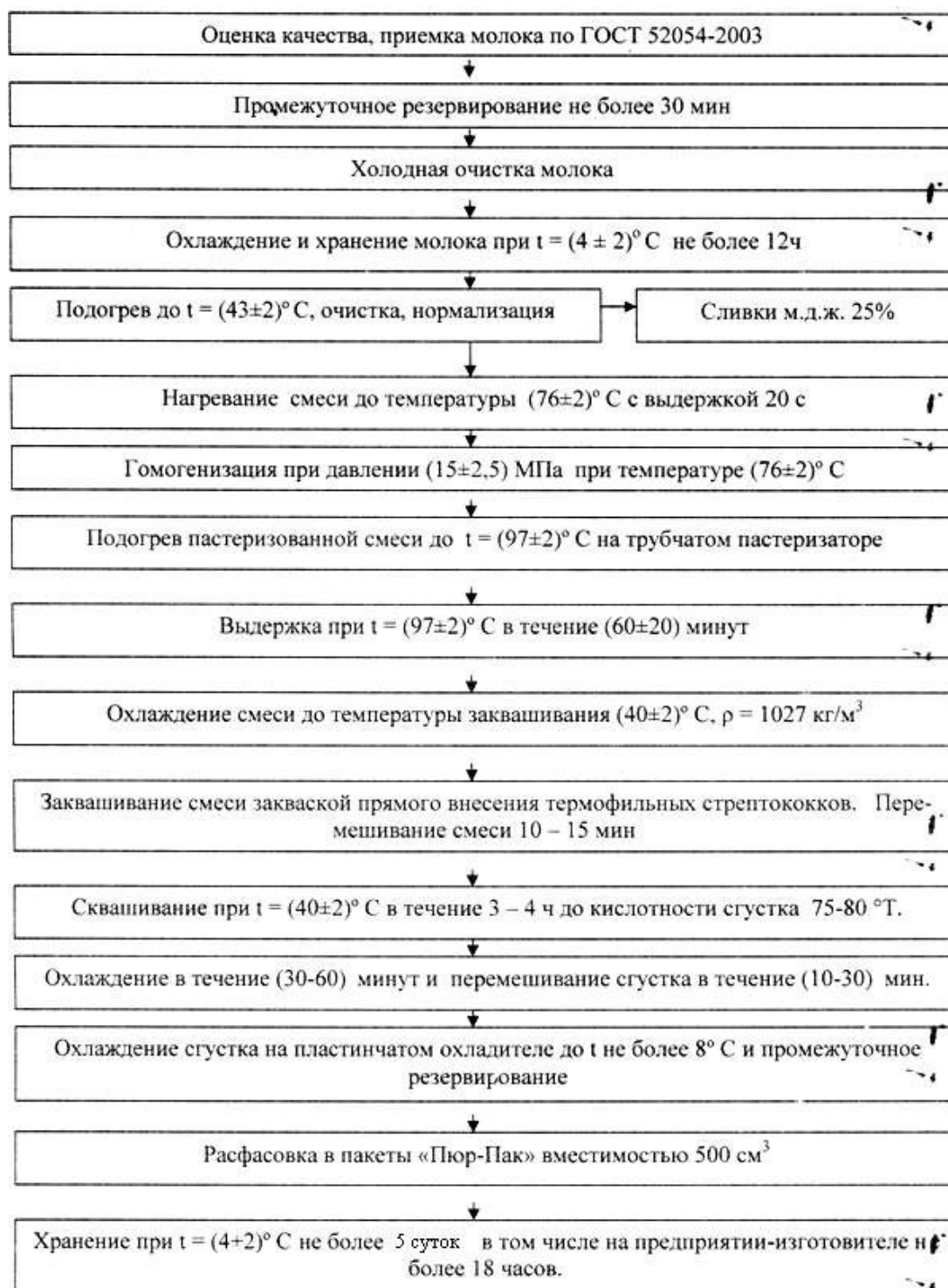
Рисунок – Принципиальная схема производства варенца м.д.ж. 2,5%
