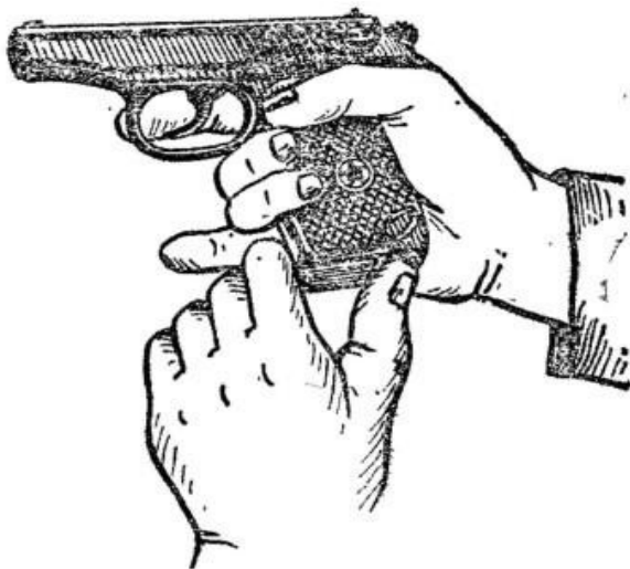
Рис. 3. Извлечение магазина из основания рукоятки
