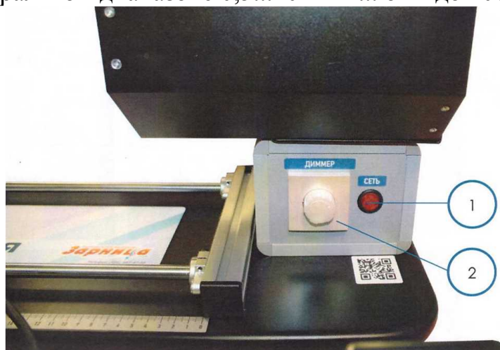
Рисунок 2.5 - Осветительный модуль: 1 - кнопка включения/выключения; 2 - диммер для регулировки мощности излучения
