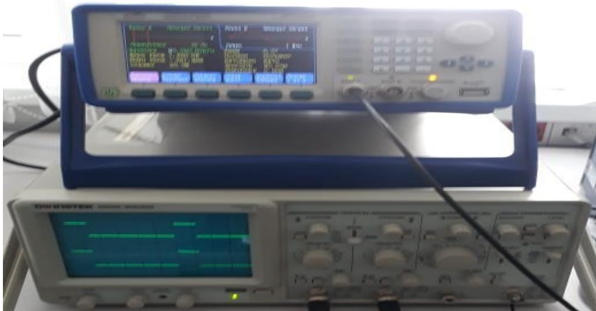
Рисунок 1 – Генератор тестового сигнала и осциллограф с изображением входного и выходного сигналов
