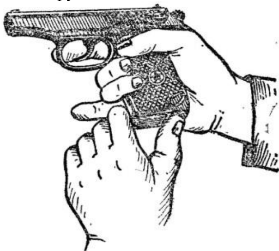
Рис. 3. Извлечение магазина из основания рукоятки
