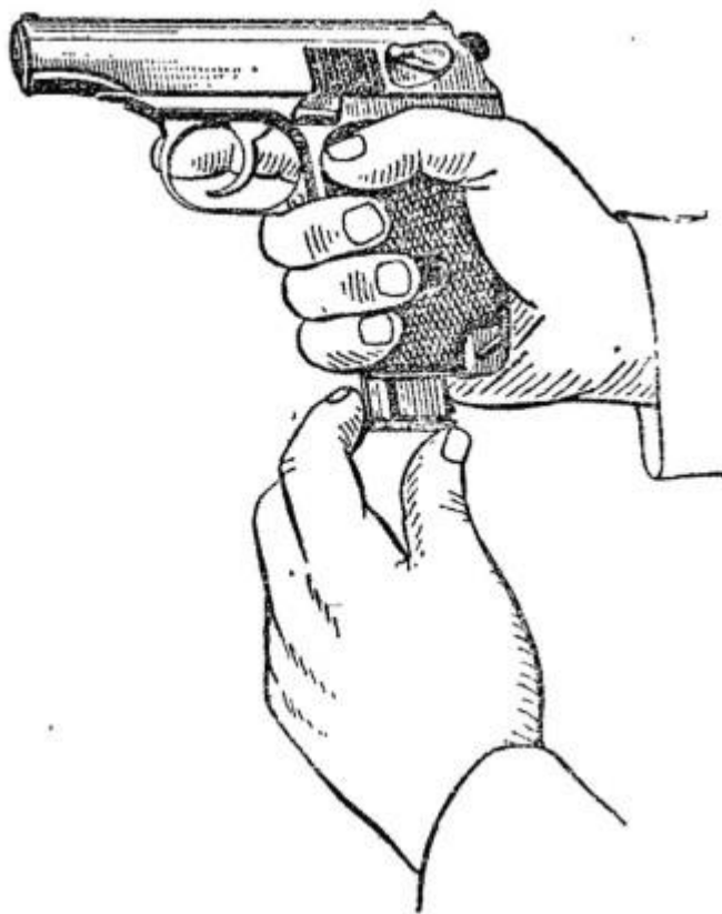
Рис. 8. Вставление магазина в основание рукоятки
