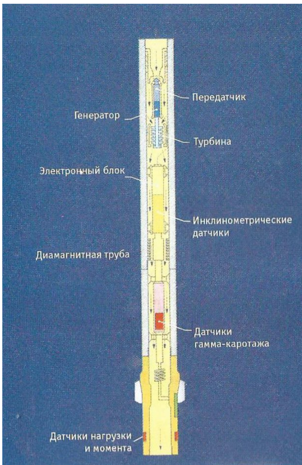
Рисунок 1 – Структурная схема телесистемы с гидравлическим каналом связи
