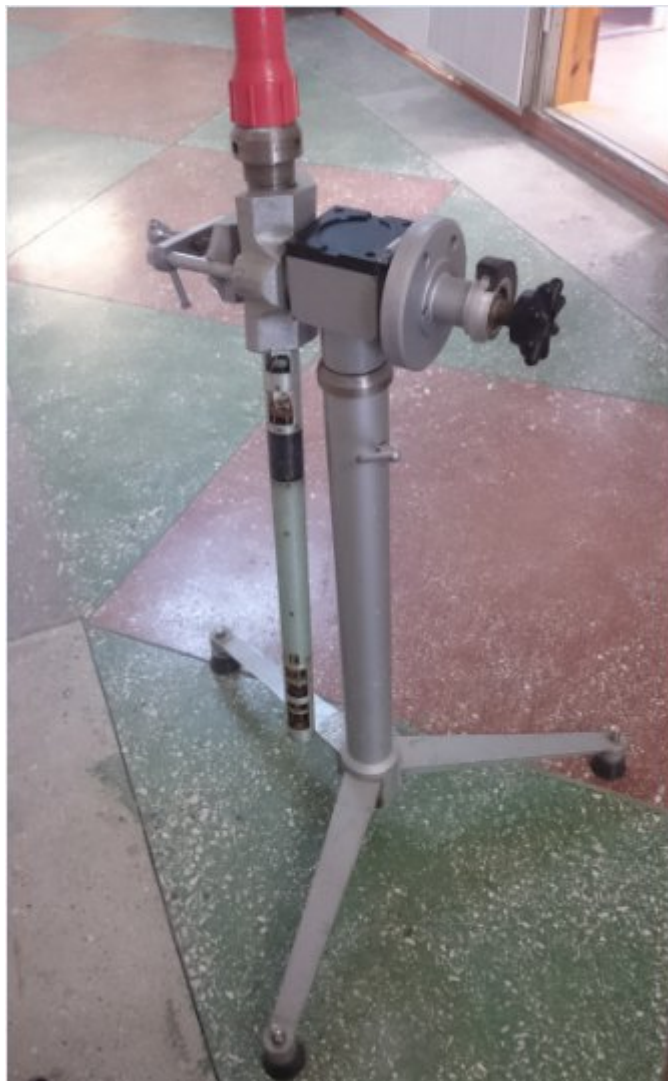
Рисунок 6 – Инклинометр на калибровочной установке
