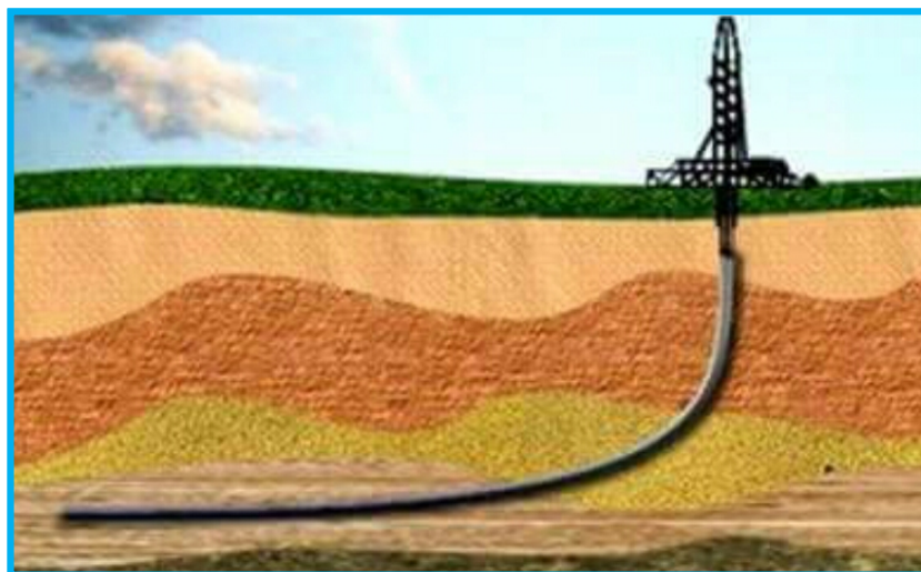
Рисунок 1 – Бурение горизонтальной скважины
