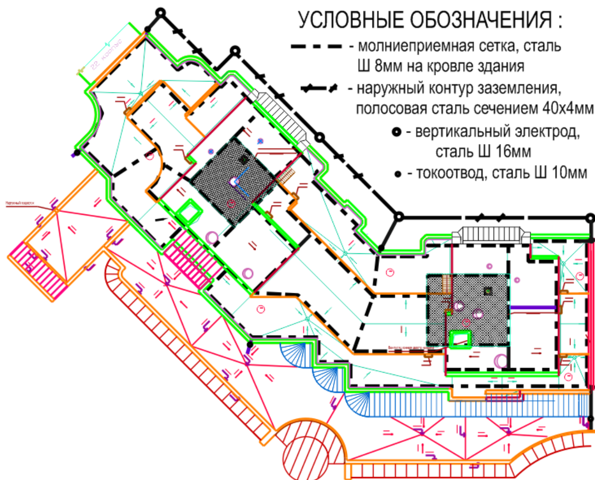
Рисунок 16.8 – Молниезащита и наружный контур заземления секции 1 дома
