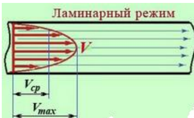
Рисунок 3.1 – Ламинарный режим движения жидкости
