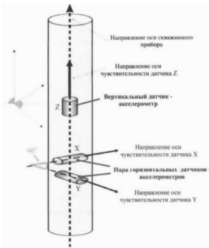
Рисунок 13.3 - Схема прибора трехкомпонентного геоакустического каротажа
