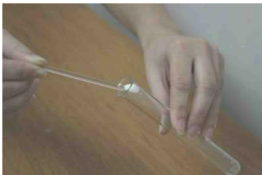
Рисунок 1.3 – Внесение в пробирку порошкообразных веществ
