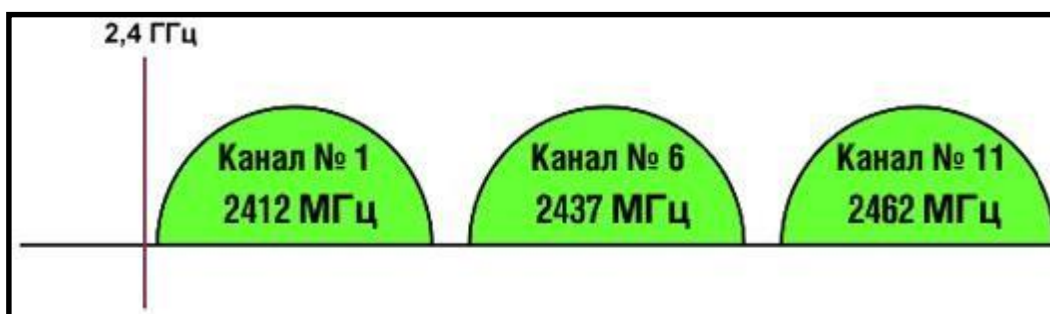
Рисунок 10.4 – Частотные каналы 1,6,11 для диапазона 2,4 ГГц
