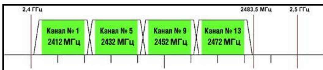
Рисунок 10.5 – Частотные каналы ETSI
