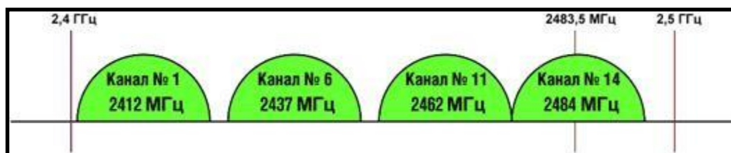
Рисунок 10.6 – Частотные каналы ETSI с поддержкой канала №14
