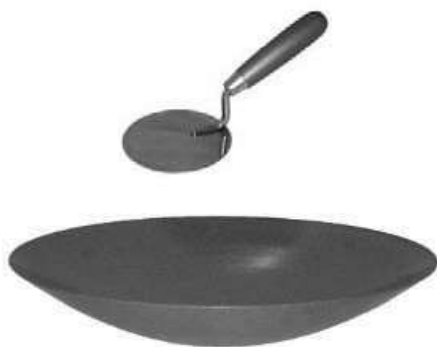
Рисунок 5.1 – Чаша и лопатка для затворения цемента
