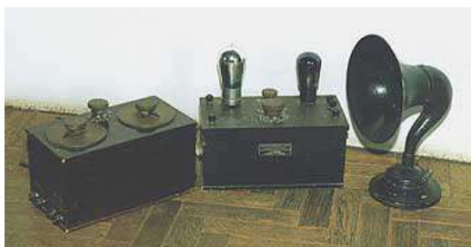
«Радиолина». Первый отечественный радиоприемник. Модель 1924 г. Трест заводов слабого тока. (Экспонат Политехнического музея в г. Москве)
