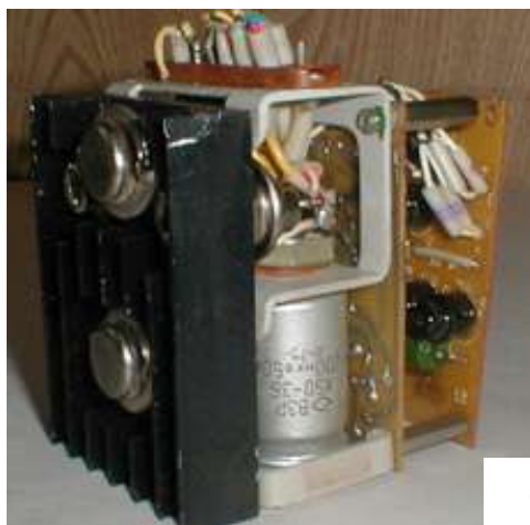
Рис. 5.5. Блоки этажерочной конструкции: а – герметичный; б – специальной формы; в – модуль блока питания
