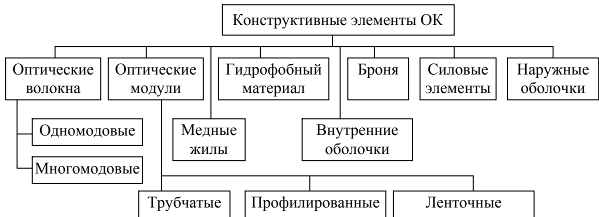
Рис. 8.8. Основные конструктивные элементы оптического кабеля
