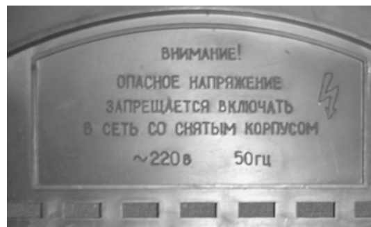
Рис. 14.2. Расположение маркировок: а — на задней панели усилителя; б — в отсеке питания пульта управления телевизором JVC; в — на задней панели приемника трехпрограммного проводного вещания; г — на нижней крышке ЭПУ «Лидер-306 моно»
