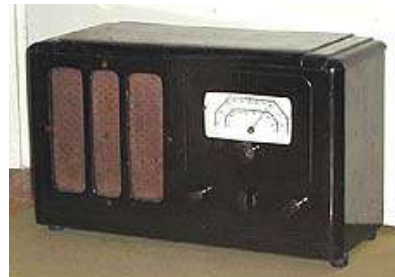
4НБС-6 (четырёхламповый настольный батарейный). Модель 1939 г. Воронежский завод «Электросигнал»
