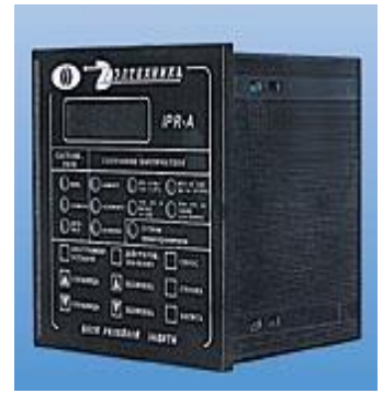
Рисунок 2.8.7 - Блок релейной защиты IPR или SMPR (могут устанавливаться другие виды защит). Функции: защита, запись аварий и событий, самодиагностика, дистанционное управление коммутационным аппаратом.
