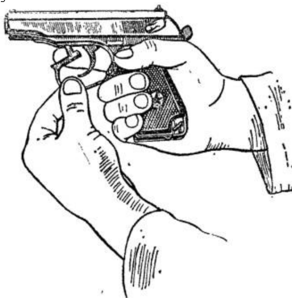
Рис. 4. Оттягивание спусковой скобы
