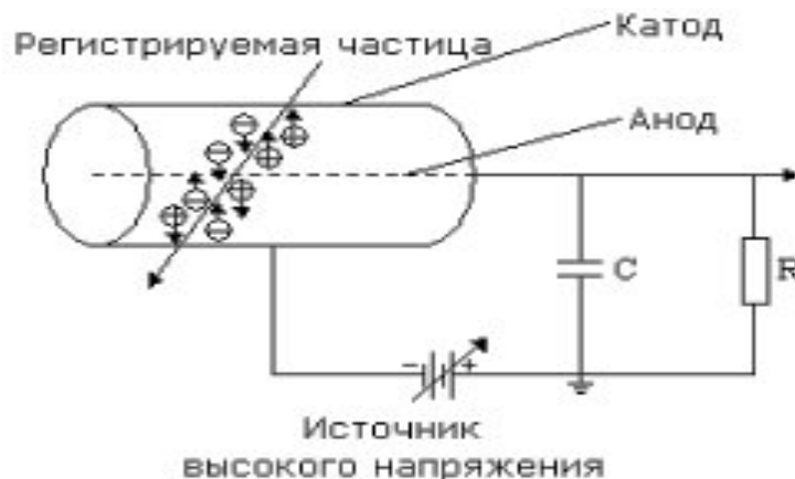
Рисунок 2. 4 – Принципиальная схема конструкции ГС
