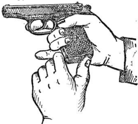
Рис. 3. Извлечение магазина из основания рукоятки
