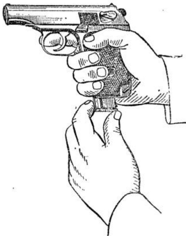
Рис. 8. Вставление магазина в основание рукоятки
