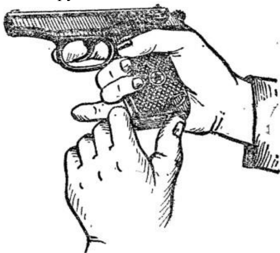
Рис. 3. Извлечение магазина из основания рукоятки
