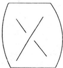
Рисунок 2.2 – Схема образования трещин чугунного образца
