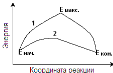
Рисунок 2 - Энергетическая диаграмма в присутствии катализатора
