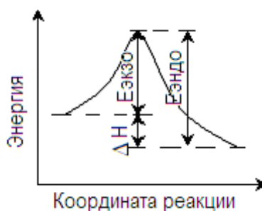
Рисунок 1 - Энергетическая диаграмма элементарной реакции
