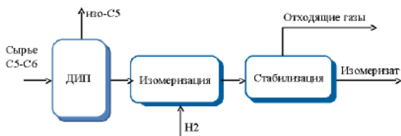
Рисунок 6 – Блок-схема процесса с ДИП
