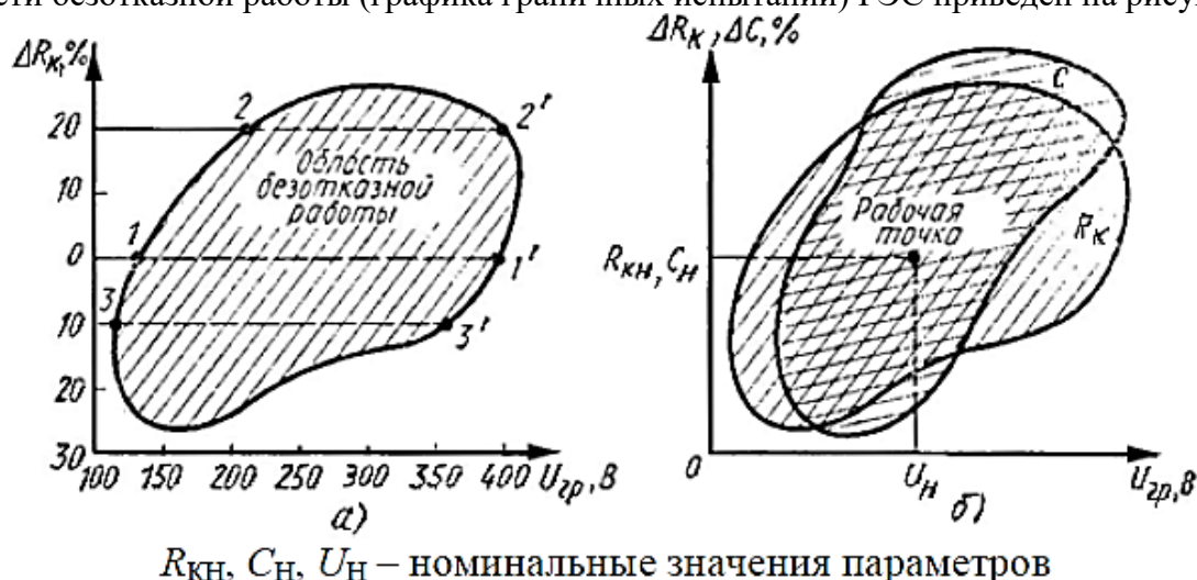
Рис. 1 – Построение области безотказной работы РЭС при изменении значений одного (а) и двух (б) входных параметров
