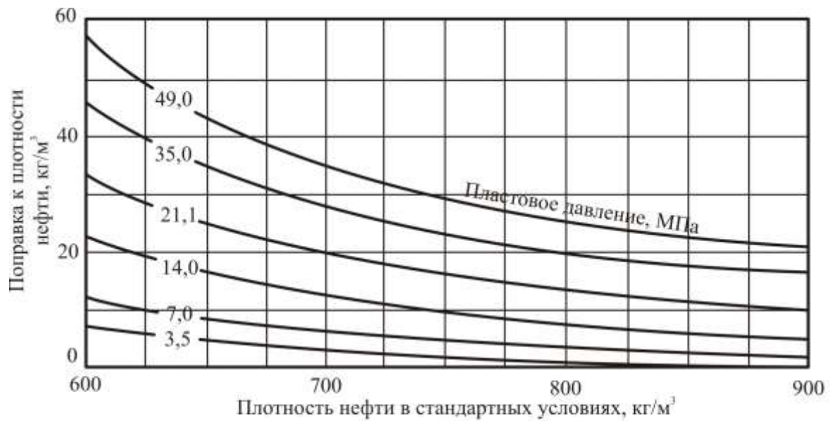
Рисунок 5.3. График зависимости \Delta \rho_P = f(\rho_{\text{н.ст}}; P_{\text{пл}})
