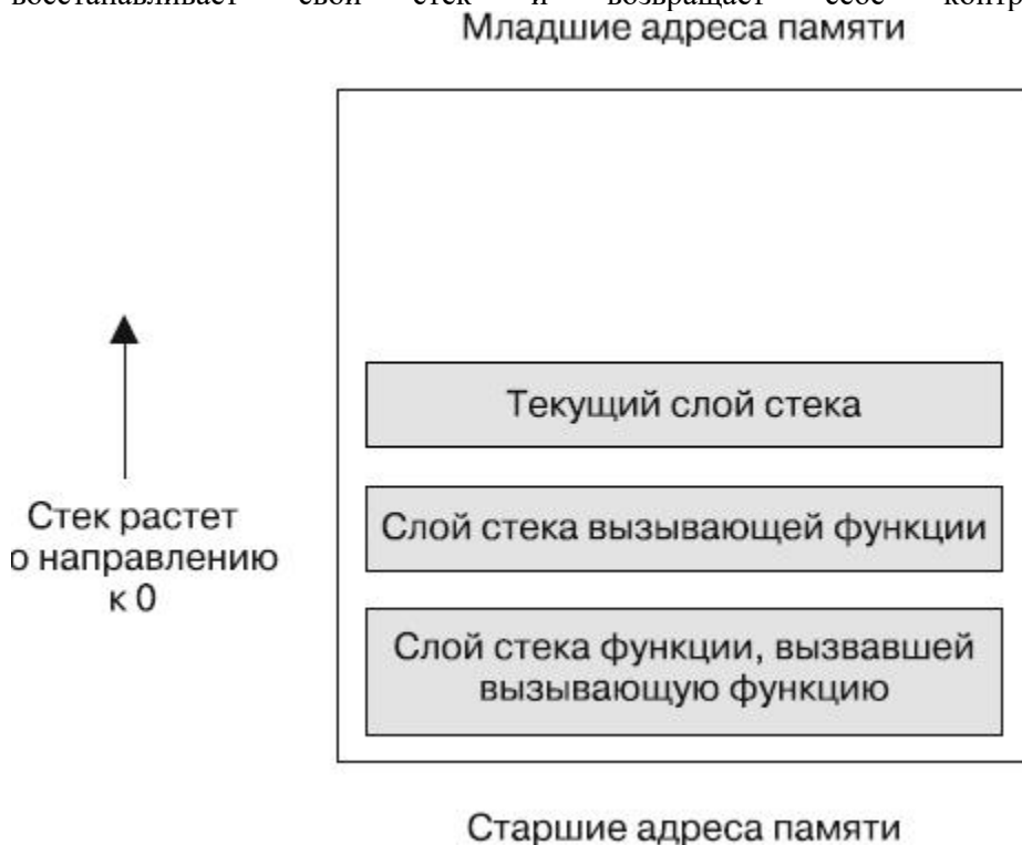
Рис. 4.7. Структура стека на платформе x86
