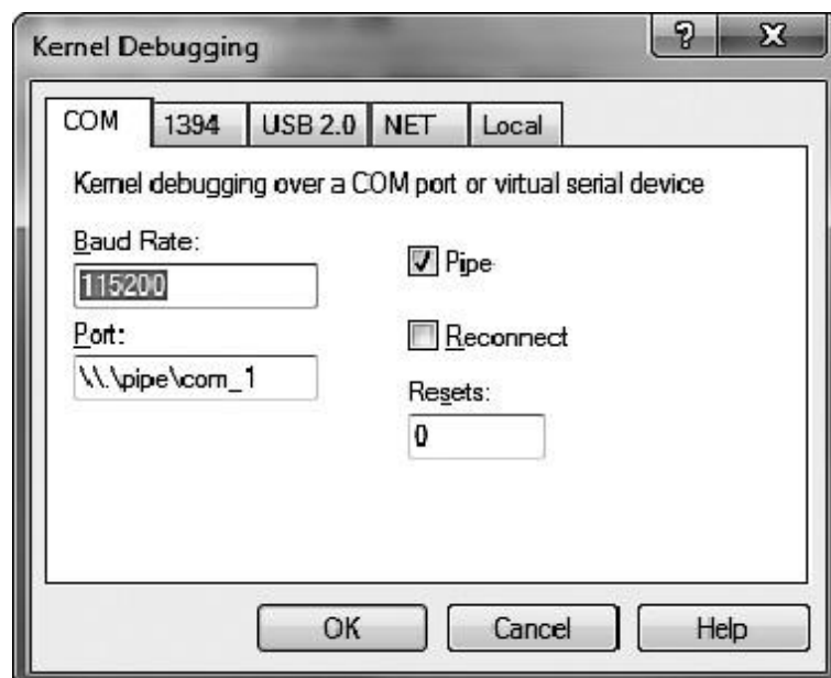
Рис. 10.3. Запуск сеанса отладки ядра в WinDbg
