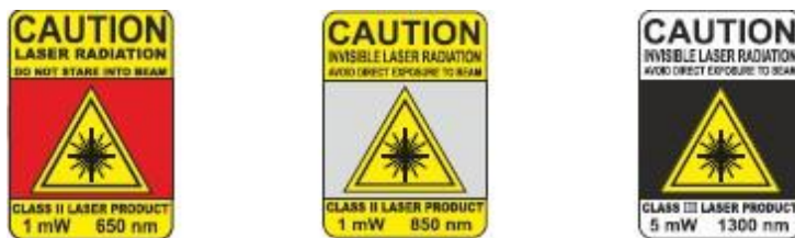
Рисунок 1 – Предупреждающие ярлыки о наличии лазерного излучения
