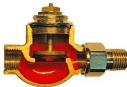
Термостатический клапан с увеличенным проходом для однетрубных и гравитационных систем в разрезе
