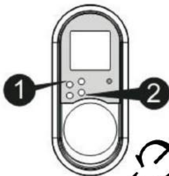
Рисунок 1.4 – Режим настройки часов
