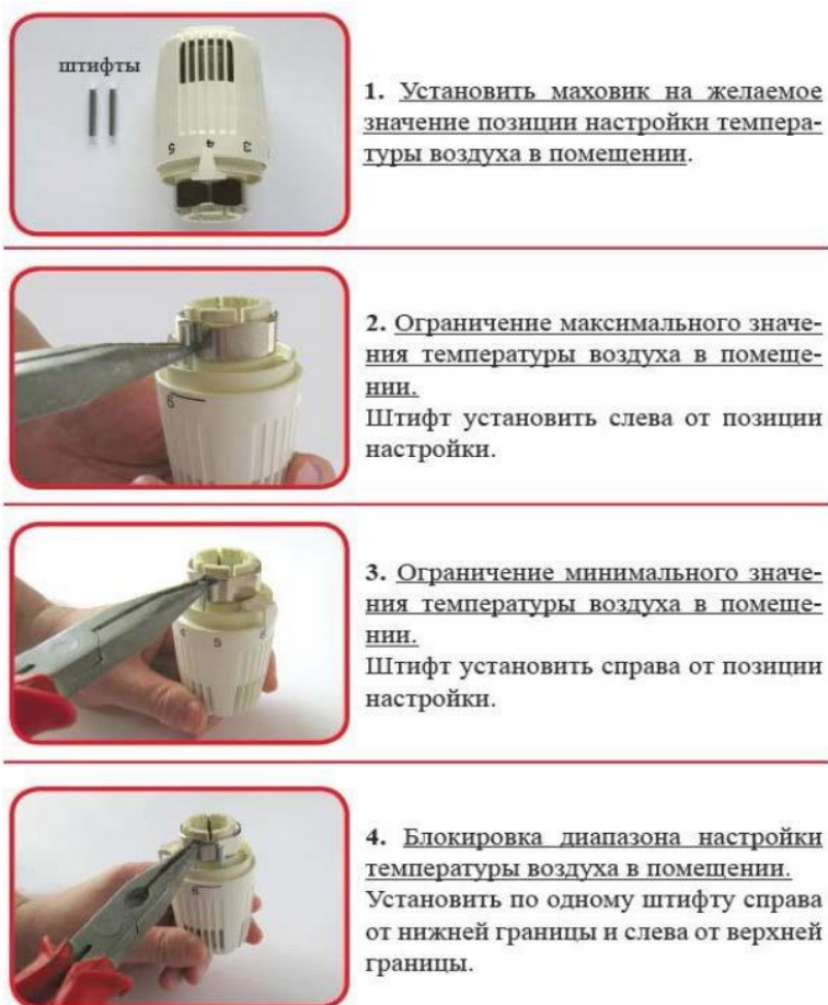
Рисунок – Схема установки ограничительных штифтов на термостатическую головку
