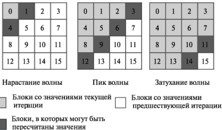
Рис. 6 - Организация волны вычислений при блочной схеме разделения данных
