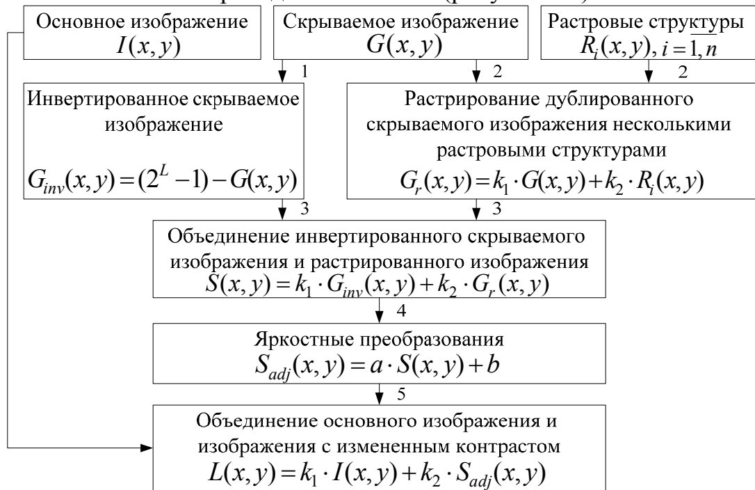
Рисунок 19.1 – Схема процесса формирования латентного изображения
