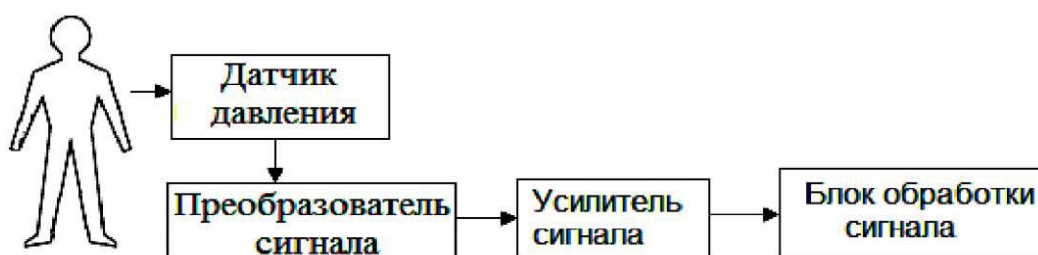
Рисунок 2.2 - Обобщенная структурная схема сфигмографического ИП артериальной пульсации крови
