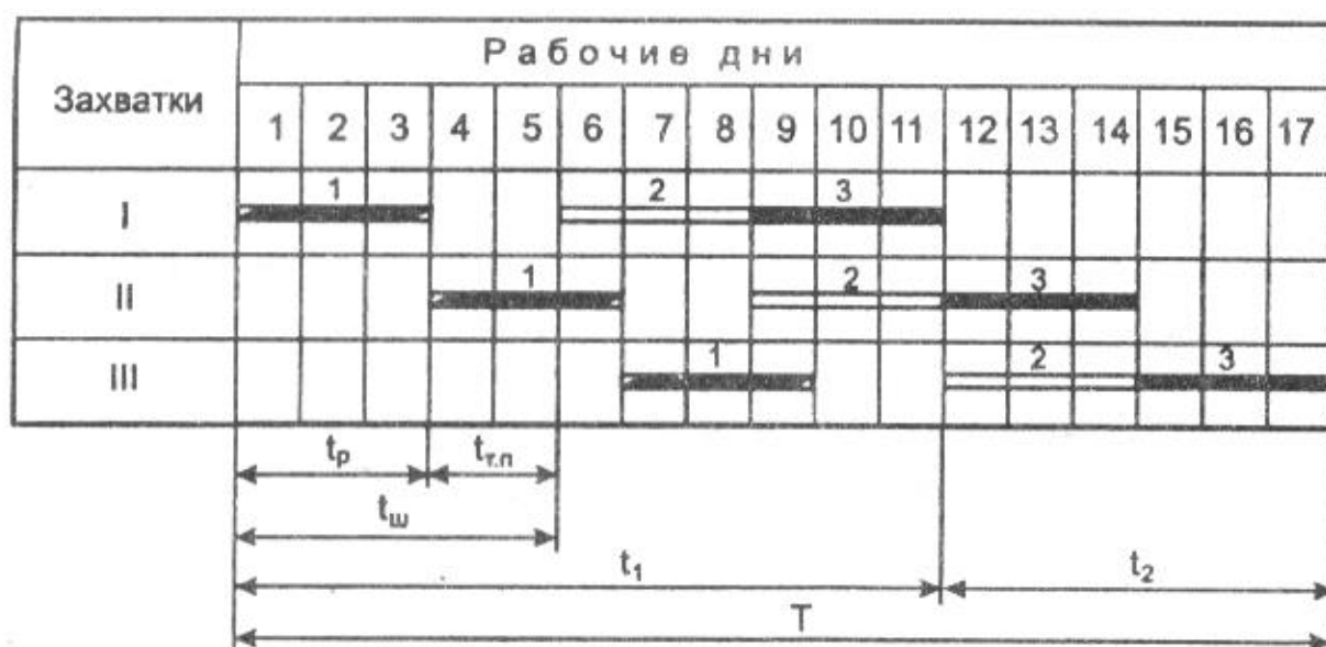
Рисунок 7.2 – Параметры строительных потоков: 1, 2, 3 – номера потоков (бригад)
