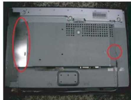
3. Снять заднюю крышку. 4. Снять защиту лампы. Отсоединить провод FUNCTION платы PCB ASS'Y.
