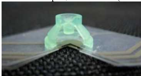
Силиконовый купол при нажатии соединяет пленки
