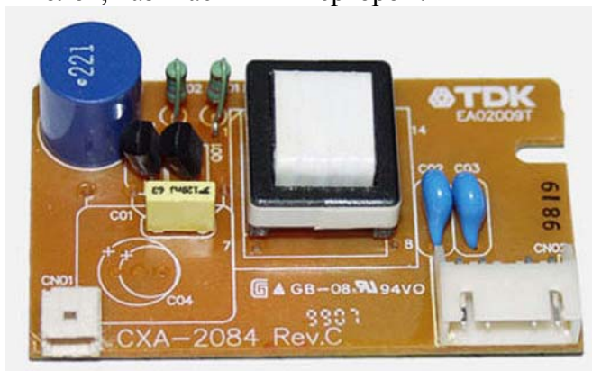
Рис. 10 - Высоковольтный модуль необходим для питания лампы
