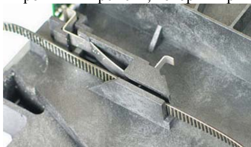
Рис. 13 - Место крепления ремня к сканирующей каретке
