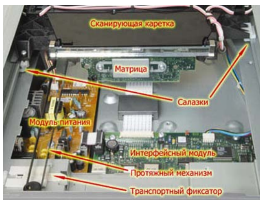
Рис. 8 - Расположение основных функциональных узлов сканера
