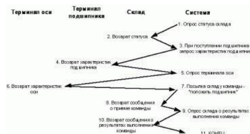
Рисунок 1 - Краткое описание тестируемой системы 'Поступление подшипника на
