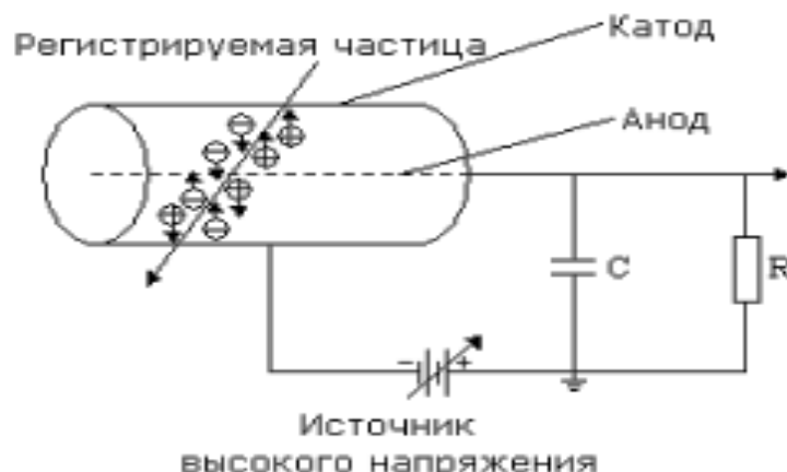
Рисунок 2. 4 – Принципиальная схема конструкции ГС
