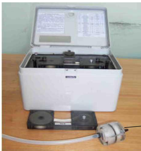
Рисунок 3.2 – Общий вид газоанализатора ГАНК-4
