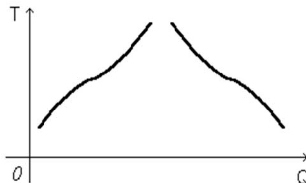
Рис. 4. Кривые плавкости аморфного тела.
